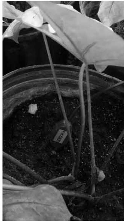
d) Instalación superficial de sondas VH400
