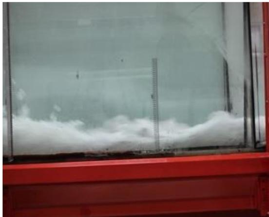
**Figura 9.** Inicio del salto hidráulico en 50 l/s.
