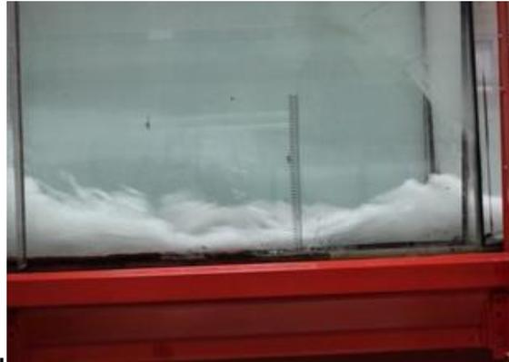
**Figura 8.** Inicio del salto hidráulico en 70 l/s.
