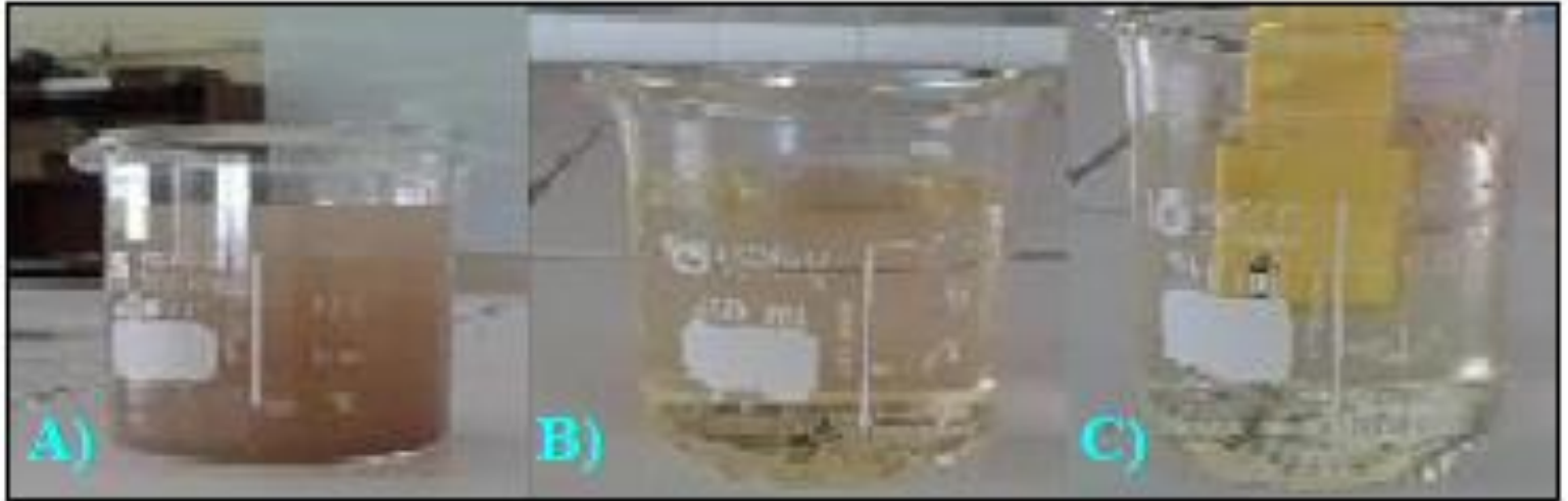
Figura 4. Secuencia del tratamiento del agua residual (A → B → C) a medida que es tratada. Se evidencia una disminución gradual en la turbiedad y los sólidos suspendidos en el agua.
