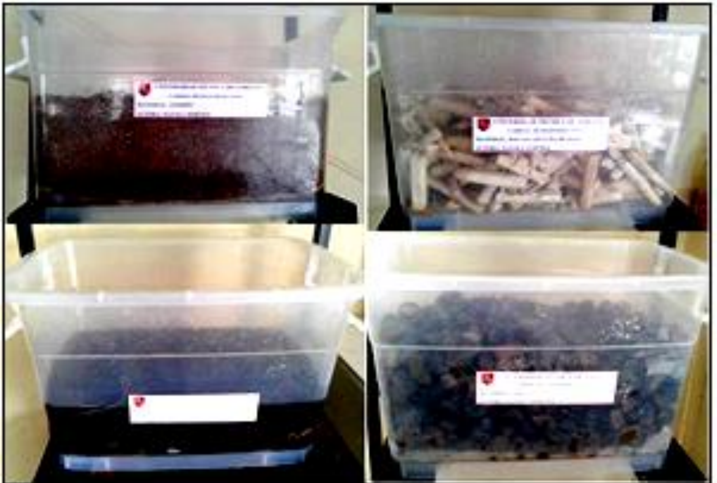
Figura 2. Materiales orgánicos utilizados para elaborar el filtro: bagazo de caña de azúcar (superior izquierda); piedra pómez (superior derecha); arena (inferior izquierda), y ladrillo triturado (inferior derecha).
