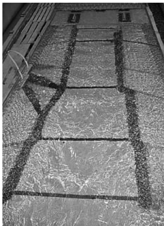
Figura 2. Modelo físico de la desembocadura del río Besòs. El flujo es de arriba a abajo. Obsérvese la retícula de traviesas y cordones de escollera.
