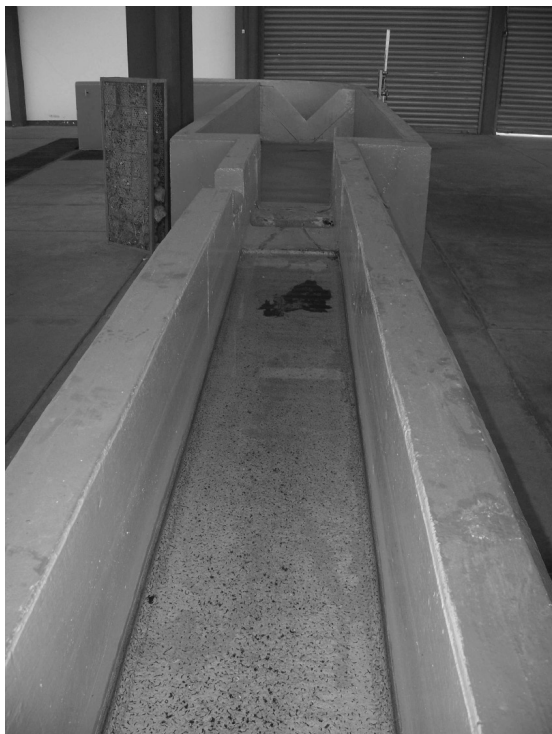
Figura 7. Parte final del canal de flujo permanente.
