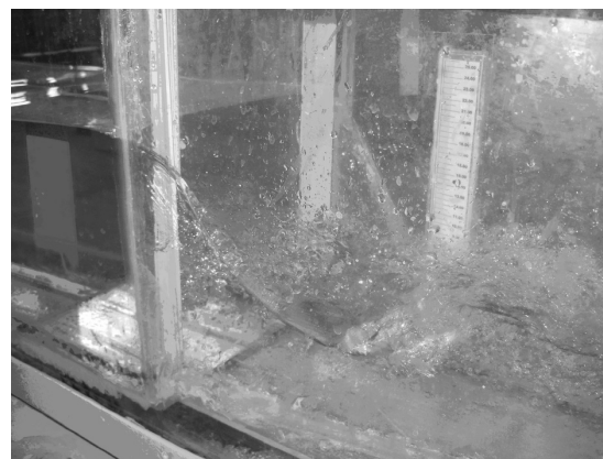
Figura 23. Placa de acrílico colocada en la entrada del aforador.
