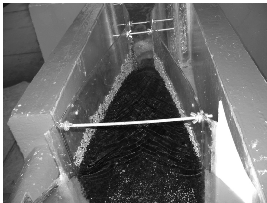
Figura 14. Aforador recubierto con arena de 5 mm.
