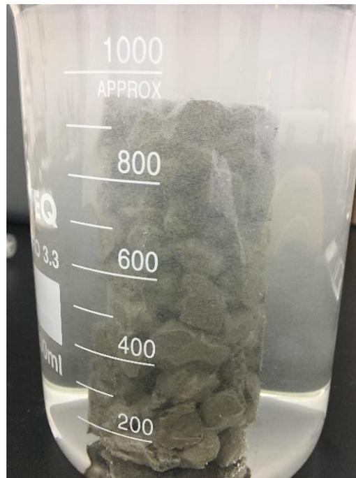
**Figura 3.** Disposición de precipitación de metales pesados en el lote reactivo.
