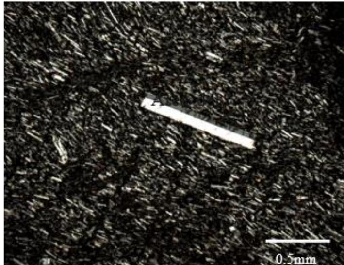
**Figura 1.** Sección delgada microscópica de roca basáltica en una escala de 0.5 mm.
