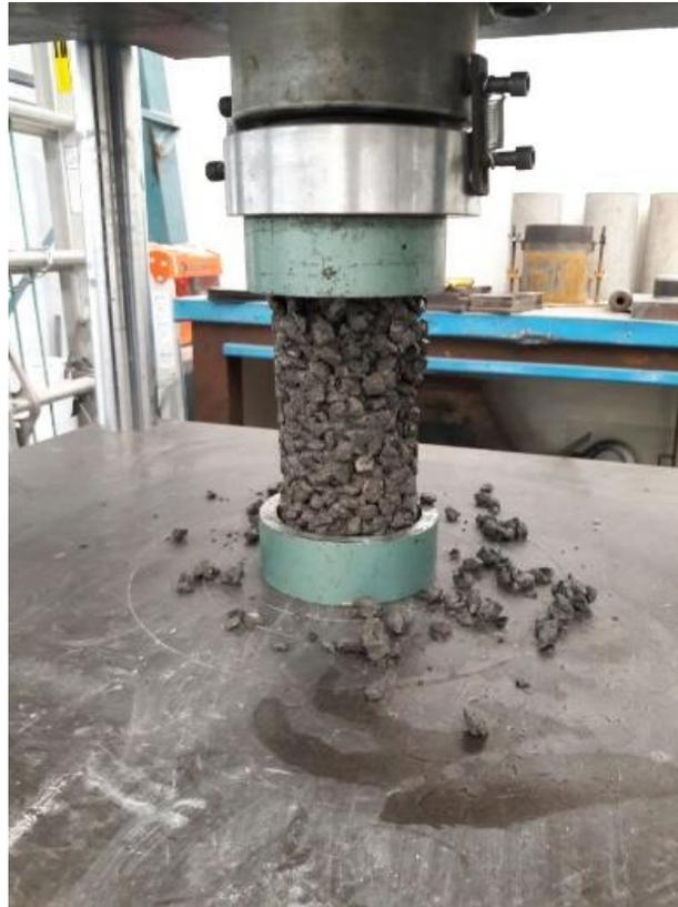
**Figura 2.** Cilindro de concreto permeable sometido a compresión.
