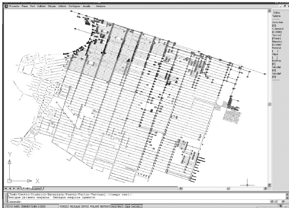
Figura 7. Resultado de la contribución de las fuentes, visualizado en el SCADRED para una red completa. Se distinguen claramente por color (tonalidades de gris) las áreas de influencia de las fuentes.
