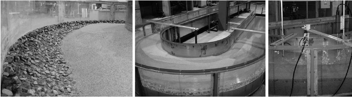
Figura 2. Izquierda y centro, protección de margen flexible y rígida con rip-rap (o escollera), respectivamente, en el modelo experimental. Derecha, medición de velocidades con ADV tridimensional y bidimensional.
