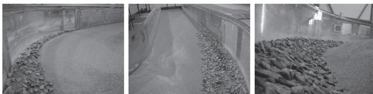
Variación del perfil longitudinal del tirante o calado normalizado hidráulico en la curva interna,  $t = 130.8$  h
