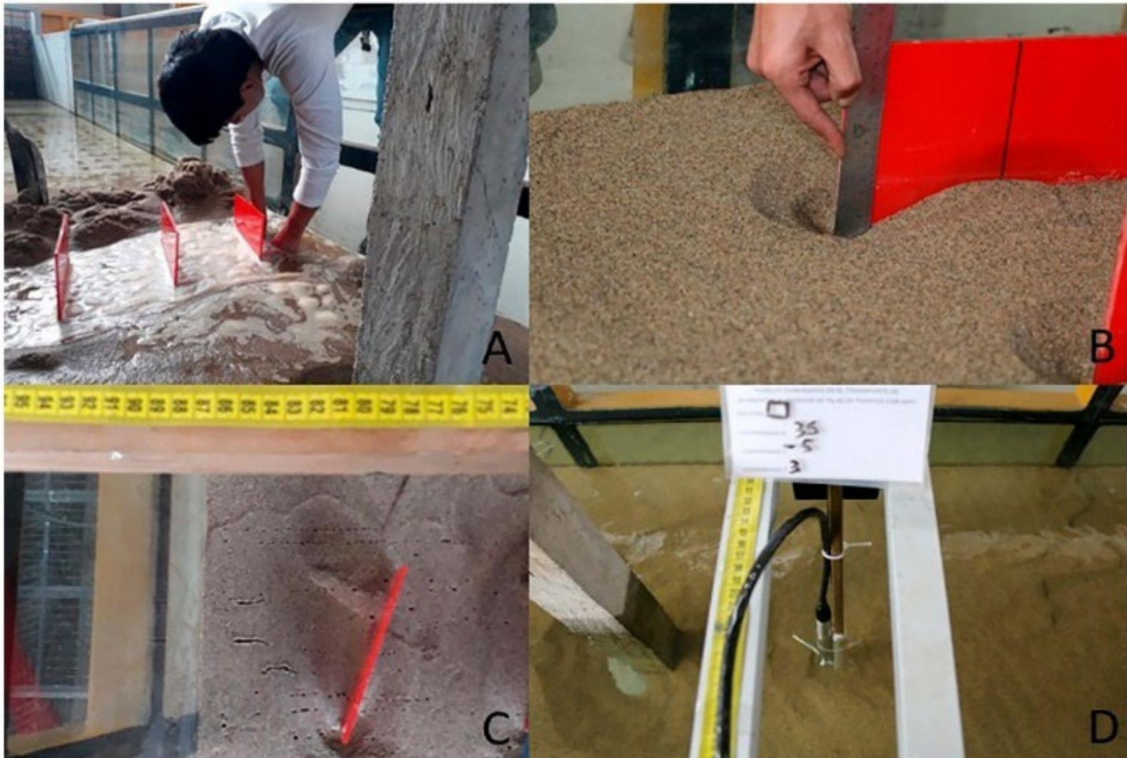
**Figura 5.** Procedimientos en la investigación: A) colocación de los paneles en el lecho; B) medición de la socavación localizada; C) batimetría del lecho; D) medición de las velocidades instantáneas.
