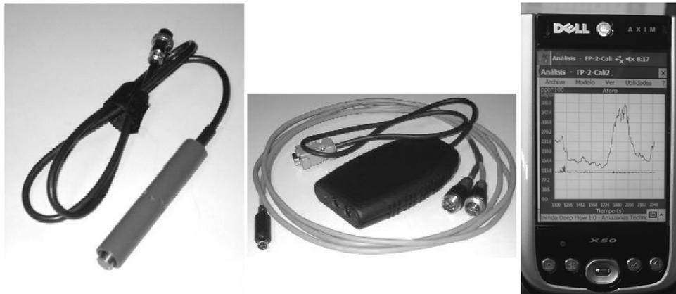
Figura 3. Equipo IDF de medición de trazadores en tiempo real.
