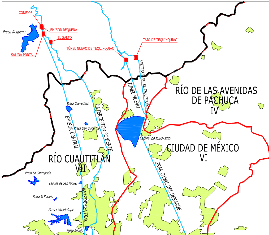
Figura 4. Sistema de drenaje a la salida de la Cuenca del Valle de México.
