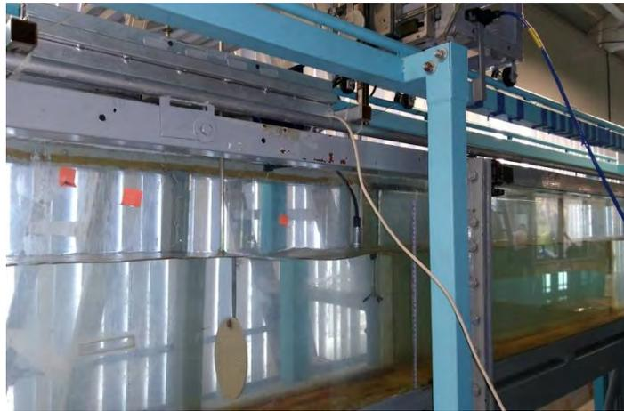
**Figura 2.** Canal experimental de sección rectangular.
