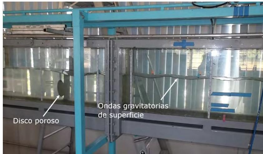
**Figura 6.** Ondas gravitatorias de superficie utilizando un disco poroso
