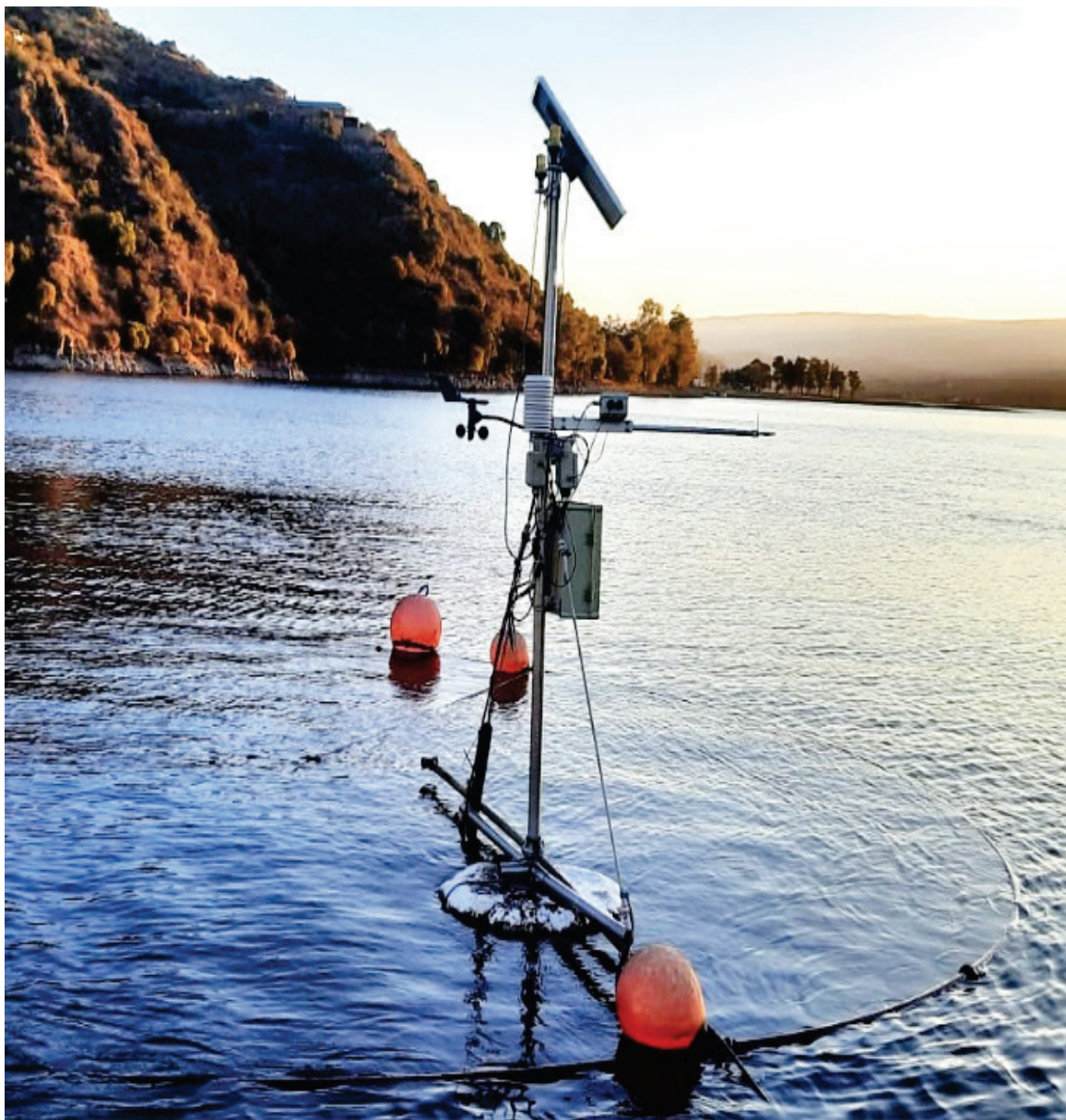
Figura 2. Estación de Monitoreo de Lagos instalada en el Embalse Los Molinos.
